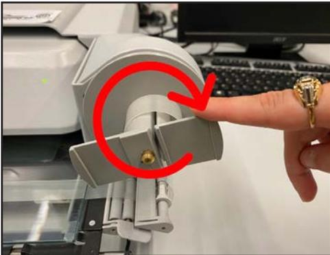
**6/ Tournez l'enrouleur dans le sens des aiguilles d'une montre afin d'amorcer la bobine.**
