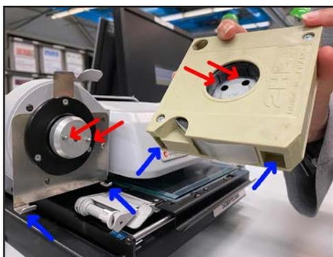
3/ Ensuite, il faut positionner la bobine sur l'adaptateur. Dans un premier temps, faites sortir le début du film de la cassette. Puis, placez les deux encoches, en bas de la cassette, sur les deux tiges métalliques et mettez les trous de la bobine en face des pics de l'adaptateur.
