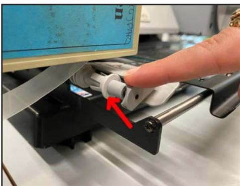
**2/** Les taquets (à droite et à gauche du lecteur) guident la bobine : il faut donc les **mettre dans la position adaptée à la taille de la bobine**, c'est-à-dire **vers l'avant** pour une bobine de 16 mm.
