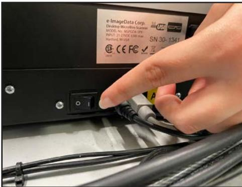
L'unité centrale et le logiciel s'allument automatiquement tous les matins. Avant utilisation, il vous faudra **allumer le lecteur-numériseur de microformes**, grâce au bouton d'alimentation situé à l'arrière de l'appareil. Une lumière verte apparaît.
