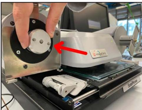
**1/** Tout d'abord, il faut **installer l'adaptateur sur l'enrouleur de gauche**. Placez-le dans la fente et vérifiez qu'il n'y a pas d'espace entre l'enrouleur et l'adaptateur.
